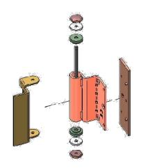
Les portes sont munies d'au moins 3 paumelles en acier galvanisé de 3 mm d'épaisseur. Leur conception et leur fabrication est conforme à la norme UNE-EN 1935 "Paumelles d'un seul axe pour portes coupe-feu.
