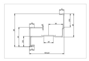
En acier galvanisé de 1,5 mm d'épaisseur ou même matériau que les vantaux.
